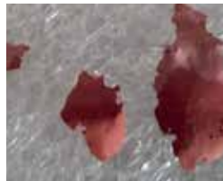
Hier is de TAPOX niet goed gemengd. Geen hechting aan de linkerzijde
